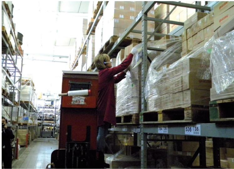
Un'operatrice in missione di picking tramite tecnologia voice: il terzo livello delle scaffalature è stato trasformato da stoccaggio a picking con il recupero di 700 posti pallet
